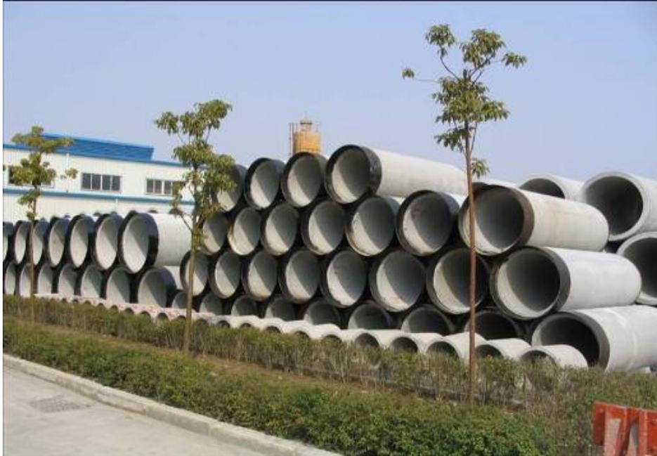
武汉双强管业生产的整体耐腐蚀钢筋混凝土顶管
