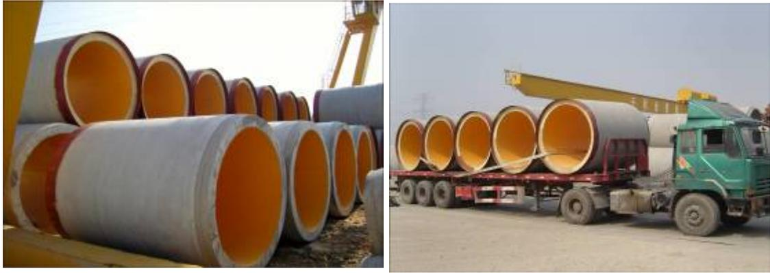
近年来，内衬式复合钢筋混凝土排水管已在城市污水管道工程中应用，最大口径可达Φ3400mm。
