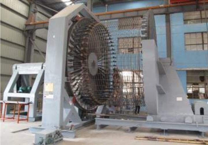
上海浦东 $\Phi 4000\text{mm}$  自动变径滚焊机
