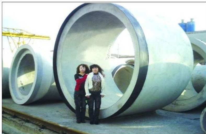
钢筋纤维混凝土管（RFCP）钢承口顶管III3000×275×2000mm
