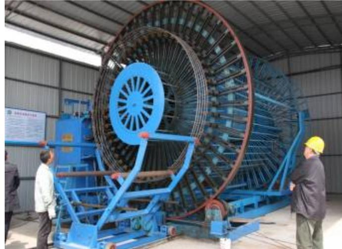
武汉双强 $\Phi 4000\text{mm}$  双筋自动变径滚焊机
