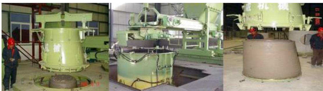
芯模振动成型预制混凝土检查井
