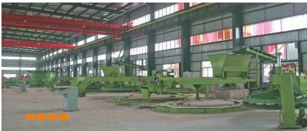
$\Phi 1350-3500\text{mm}$  双坑位芯模振动制管机
